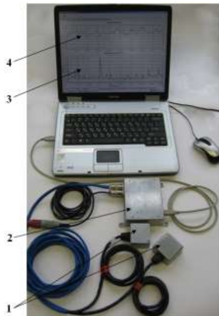
Fig. 1. Attrezzature APC: 1-moduli inerziali; 2-elettronica; 3-grafico IRI; 4-Date di velocità del veicolo
